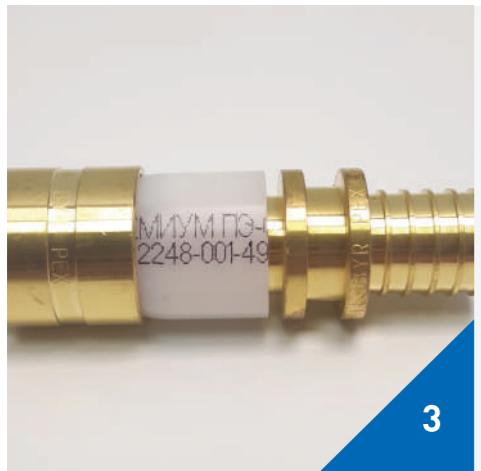
Задвинуть аксиальный фитинг в трубу, не доводя до упора 3-5 мм.
